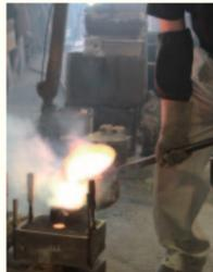
溶けた金属を型に流し込む鋳込み風景
