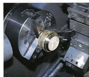
切削実験により合金の加工性を分析
