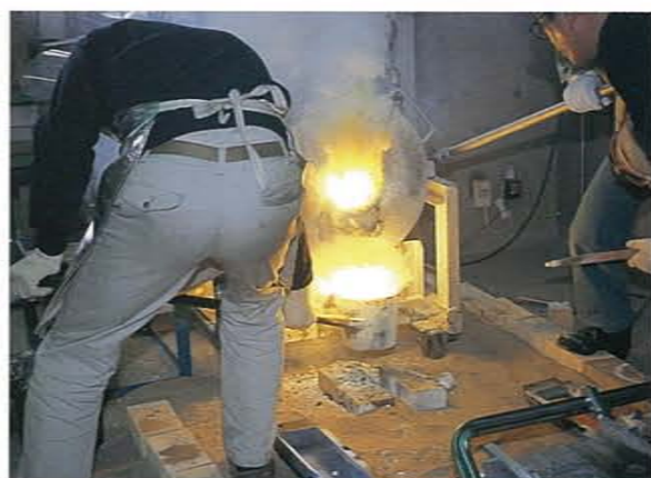
鑄造場内のガス炉を利用し、鉛レス銅合金開発に向け実験
