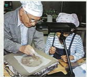
型押しの際の様子。半乾燥の型に模様を書いた和紙を張り、鑄で模様を浮き出させるように押していく。
