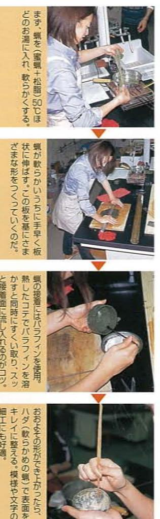
高岡銅器の伝統的な鋳造方法には、蝶型、双型、焼型などがある。なかでも今回挑戦した蝶型は、最も精度の高い一品製作の技法だ。蝶でつくった原型を粘土分を含む砂で包んだ後、焼いて蝶を溶かし出し、その隙間に金属を流し込む。蝶によってかたどられた作者のイメージは、原型そのままのしなやかさを保ちながら金属に生まれ変わるのだ。熟練の職人ともなるとレースのように繊細な透き模様や髪の一本まで表現できるという。
