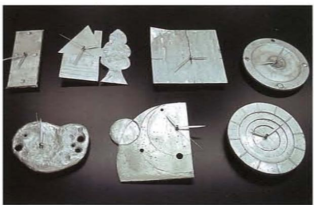
同フェスタの期間中に実施されたワークショップには、フォーラム出席者のうち11名が生型铸造法による掛け時計の製作に挑戦した。参加者は、鋳物の素材として再利用するため生活中でゴミとなったアルミ缶を持参。原型と砂型の製作から鋳造・仕上げまでの工程を体験。ひとり20個集めたジュースやビールなどの350ml缶は、参加者それぞれの感性を映した鋳物時計の文字
