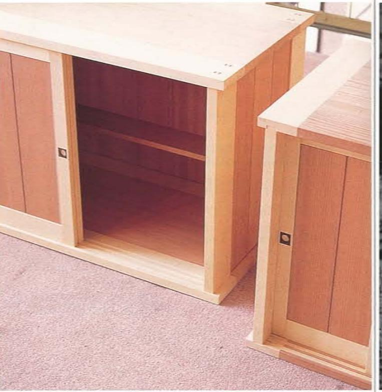
呂(漆の乾燥棚)だ。同社が富山県産のスギ材による商品開発を依頼。小松教授のアドバイスもあって、平川さんが以前の実習で製作した漆風呂のリ・デザインに取り組んだ。高岡や輪島など漆器の文化教室など一般需要の開拓も視野に入れた。漆は湿度に反応して固まるため、低価格で新しいスタンダードとなる製品開発を目指して、プロの職人以外にも文化教室など一般需要の開拓も視野に入った。漆は湿度を保つことが漆風呂の条件となるが、試作品はスライド式の板に水を含ませるという従来にない構造で対応している。平川さんは「品質を下げるコストを下げる」とに苦労しました。販売を想定した製作
