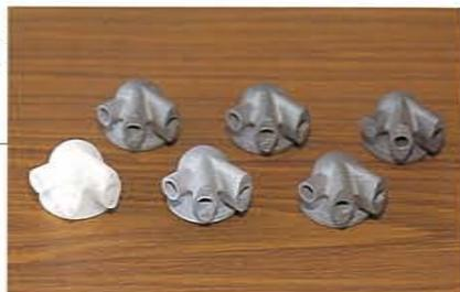
特種金属の鋳造見本として同社がつくったサンプル。手前左より粉末成型のモデル、アルミ、ステンレス。後列左よりコバルト、ニッケル、チタンと並ぶ。
