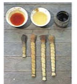
ブロンズ鋳物板を炭火にててから、お歯黒液を塗る・バーナーで加熱する、を繰り返す。炭火のあたり具合によって模様の出方が異なり、またお歯黒液を塗る・再加熱するの回数によって模様の濃淡が違う。表面のツヤも、塗料では出せないクリアなものになる。
