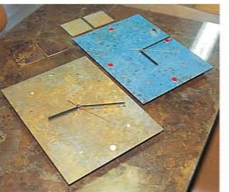
試作品の時計。文字盤に着色の技術が応用されている。銅・真鍮板にその素材の特質(薬品や熱で反応する各素材発色の違い)を活かし赤味・茶味・青味の模様を出す。着色の技法は組み合わせにより何十種類もある。
