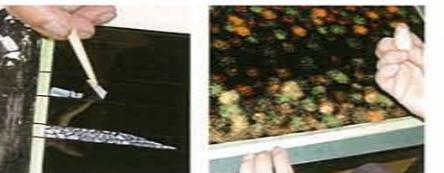
漆塗りの工程。右: 黒漆下地に模様つけ。左: 螺鈿の張り込み。
