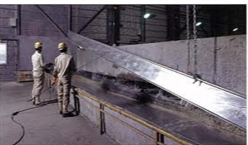
長さ12.5m、幅2.1m、深さ2.8mの大型めっき釜。同社にはこのほか中型1基、小型1基のめっきラインがあり、月当たりのめっき処理能力は小物で約700t、長尺物では約2000t。来年夏までには工場を新設し、最新ライン2基の増設を予定している。
