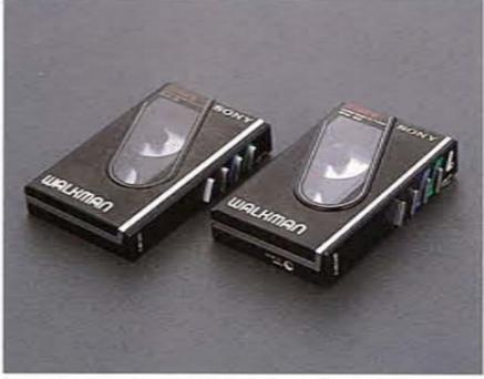
右が実物のウォークマンで左がそのモックアップ(実物大に作った模型)
