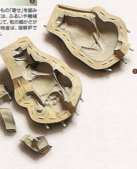
【焼型铸造法】鋳型は、粘土や水、和紙の繊維を調合した土などでつくり、約900度で8~15時間程度かけて全体を素焼きにする。これを約400度まで自然冷却させ、溶かした地金を流し込む。地金が一気に冷めないので、きめ細かい焼型に仕上がり、着色によって独特の艶や深みのある色が表現される。鋳物の材料には、比較的銅の成分が多い地金を使用。原型を損なわずに、小型から大型まで複雑な形状を再現できるため、仏像、図書、香炉などの製造に適している。
