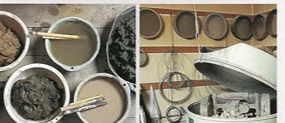
①形状によっては、いくつもの「寄せ」を組み合わせる。②土の混合には、ふるいや機械などを使う。③用途に応じて、粒の細かさが違う土を使い分ける。④地金は、溶解炉で約1,200度に熱して溶かす。
