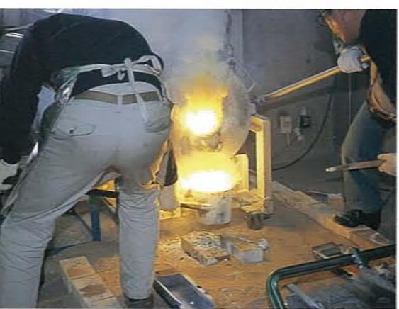
鋳造場内のガス炉を利用し、鉛レス素材開発に向け実験
