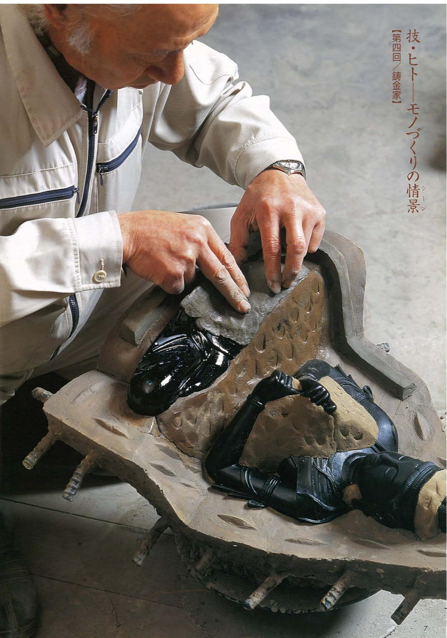
鋭い視線で原型を凝視し、その形状をあらゆる角度から分析する。複雑な原型から鋳型を外すには、いくつものディテールに分割しなければならない。多いときには、百を超える部分的な鋳型から一つの鋳型が構成されることもあるという。瞬時に頭の中で組み立てられた鋳型のイメージは、熟練した手技で形状一つひとつが忠実に再現され、原型の分身と化す。たとえ寸分の狂いなく仕上げた鋳型でも、まだ完成品とはいえない。技と精神を込めて生み出した土の「作品」は、壊されて鋳物に姿を変えた瞬間、はじめて完成するのだ。
