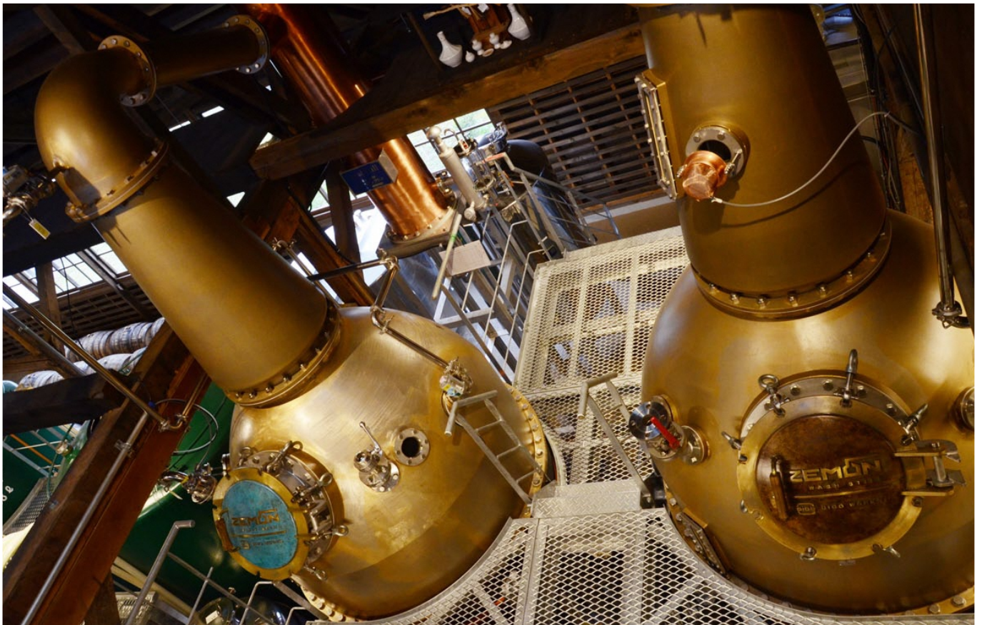
「ZEMON」はネックが短いランタン型で、ラインアームが下向きの設計により厚みのある味になる。ポットスチルの形状はウイスキーの味を左右する大きな要素。ウイスキーの蒸留は発酵させたアルコール含有物を複数回蒸留することでアルコールの度数を高める。蒸留器から留出した「ニューポット」と呼ばれる未熟成のアルコール度数は70%。
