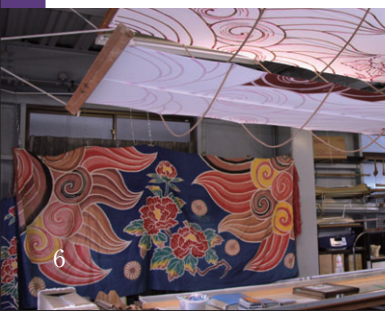
奥の壁に掛けてあるのが「見本」。のり置きした生地を上上げて乾かしている。
